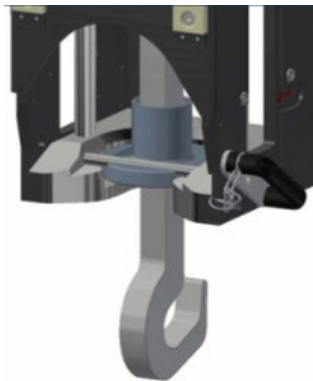
Figure 7 : Protection supplémentaire contre la chute de la charge
